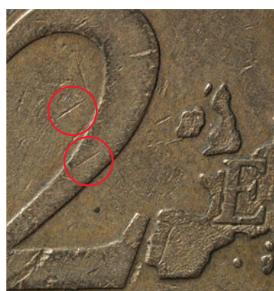
Leica LED3000 MCI: Mit linkem Beleuchtungsbogen werden Kratzer anderer Orientierung sichtbar
