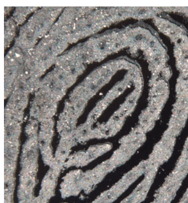
Leica LED5000 MCI: Fingerabdruck auf einer CD im Schräglicht
