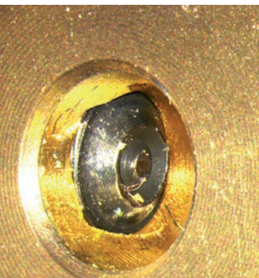
Leica LED5000 NVI: Innenaufnahme einer Madenschraube in einem Messingzahnrad
