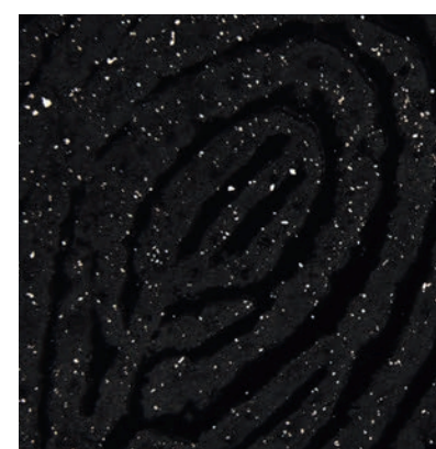
Leica LED5000 MCI: Dieselbe Probe im flachen Auflicht. Deutlich sichtbar: Staubpartikel
