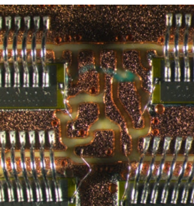
Leica LED3000 SLI: Anschlussdrhte auf einem Elektronikboard werden durch seitliches Licht hervorgehoben
